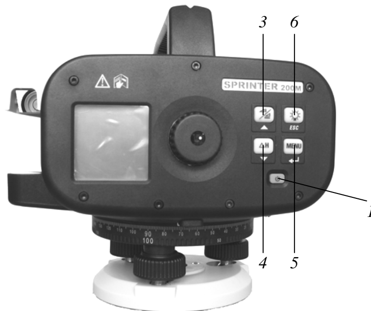
Рис. 2. Панель керування нівеліром Sprinter 200M
